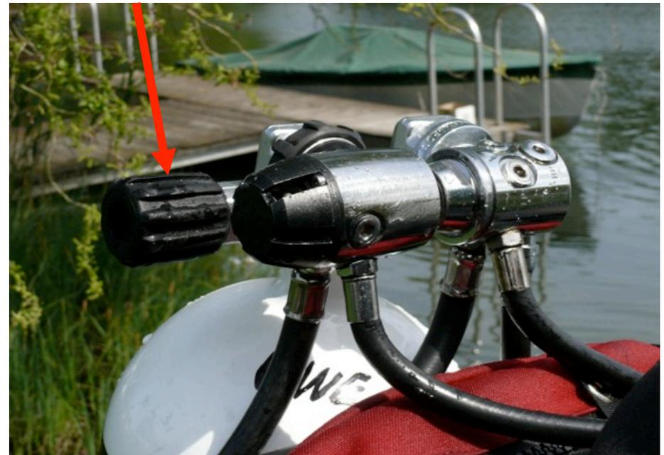
Erste Stufen werden waagrecht montiert. Alle Schläuche sind nach unten gerichtet. Das Handrad ist ohne Hindernisse zu erreichen.
